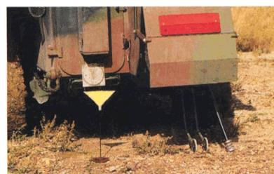
Le système de balisage et de prélèvement
