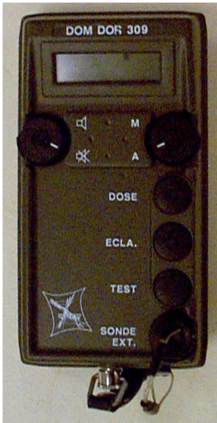
Elle est conçue pour être utilisée avec sonde interne (détection de rayonnement  $\gamma$ ) ou sonde externe ( rayonnement  $\gamma$  seul ou  $\gamma$  et  $\beta$  ).
