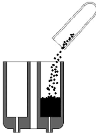
4- Puis mettez le tampon de **bourre** par dessus la poudre noire, il faut que le niveau de celle-ci arrive 6 à 8 mm en retrait par rapport à l'entrée de la chambre et cela pour que la balle ait la place de se loger. **Une balle qui dépasse bloque le barillet**.
