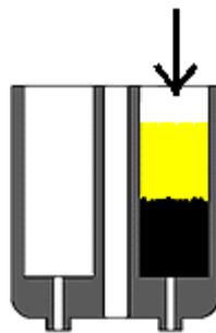
5- Une fois la poudre et la bourre installée, vous pouvez présenter **la balle de plomb** en la plaçant sur l'entrée de la chambre du barillet; faites pivoter celui-ci afin que la balle soit juste **sous le refouloir**, et d'une main ferme faites **descendre la balle dans la chambre à l'aide du refouloir**, puis faites en sorte que la balle se trouve juste d'un ou deux millimètres en désaffleur par rapport au dessus du barillet. Je le répète, une balle qui dépasse bloque la rotation du barillet.
